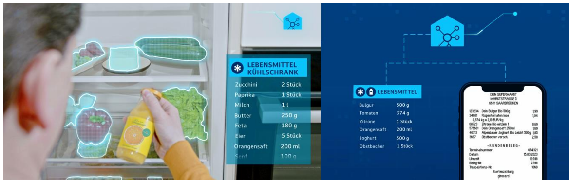
Abbildung 31: Veranschaulichung der Produkterkennung im Kühlschrank mit Hilfe von im Kühlschrank installierten Kameras (links) und der Fusion der erkannten Produkte mit den abfotografierten, digitalisierten Kassenscheindaten (rechts) zum Aktualisieren des Haushaltsbestands.
